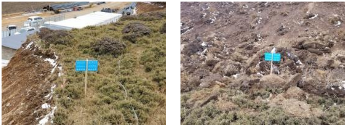
图 1-15 简易坡面量测法
